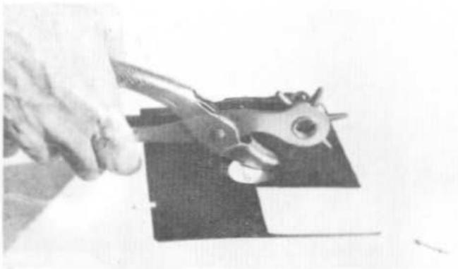
Foto 5 - O alicate no momento do furo. Note-se os pedaços de papel na parte de dentro do disquete, abaixo do alicate. Eles vão impedir que o alicate danifique o disquete
